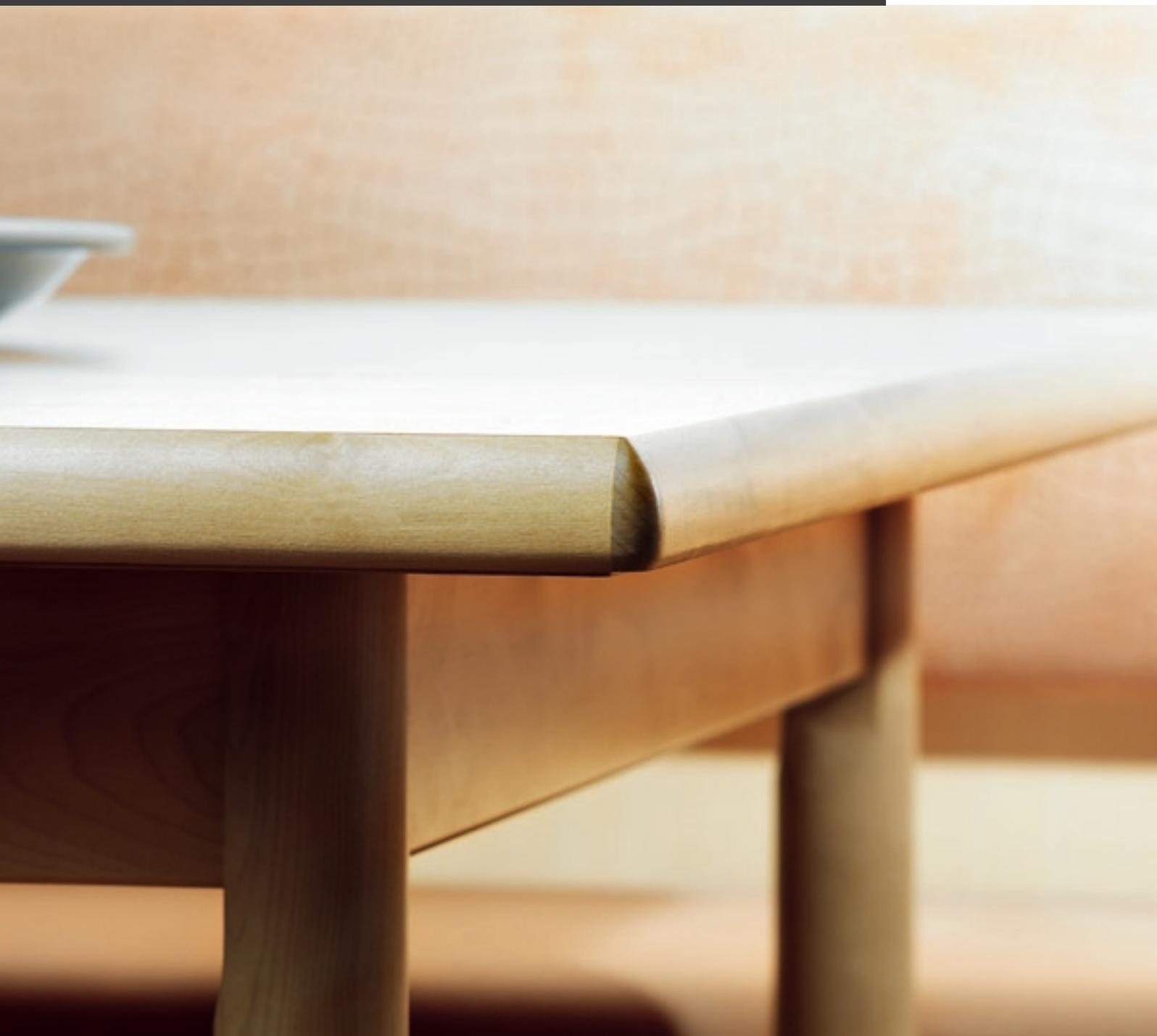
Les bords en bois massifs jusqu'à une largeur de 28 mm sont fraisés rapidement et de façon sûre au moyen d'une combinaison entre défonceuse et accessoires pour couvre-chants massifs.
