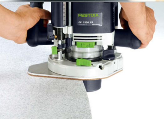
Fraisage minutieux des rebords – avec une large semelle pour une parfaite stabilité de la fraiseuse. Semelle qui peut être remplacée sans outil par la semelle normale.
